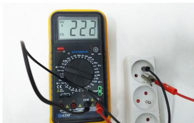
Fig.b Tension entre la borne phase et la terre.
