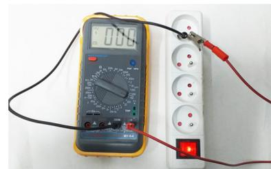
Fig.c Tension entre la borne neutre et la terre.
