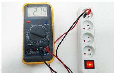
Fig.a Tension entre la borne phase et la borne neutre.
